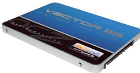
Серия Vector 150 основана на двухъядерном восьмиканальном контроллере Indilinx Barefoot 3 версии M00. Причем одно ядро имеет архитектуру ARM Cortex, а другое, OCZ Aragon, представляет собой специализированный 32-бит RISC-процессор, функционирующий с частотой 400 МГц, который спроектирован для работы в составе SSD.
