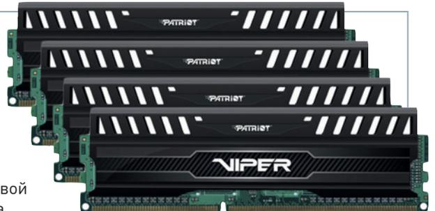
При разгоне нам удалось увеличить частоту до 2300 МГц, но при этом наблюдались периодические «зависания». Оптимальным оказалось значение 2272 МГц, при котором система функционировала стабильно.
