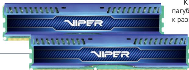
и напряжении 1,5 В. Впрочем, энтузиастов оверклокинга мало интересуют режимы работы по умолчанию. Разгонный потенциал продукта можно охарактеризовать как неплохой: при напряжении 1,65 В значение тактовой частоты достигло 2278 МГц при задержках 12-12-12-27.
