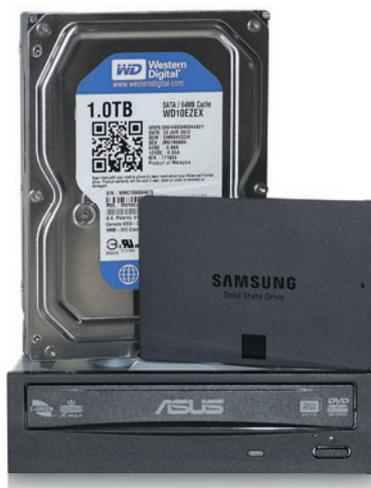
Подсистему хранения составили твердотельный накопитель Samsung, жесткий диск WD, имеющий емкость 1 Тбайт и скорость вращения шпинделя 7200 об/мин, а также оптический дисковод ASUS DVD-R
