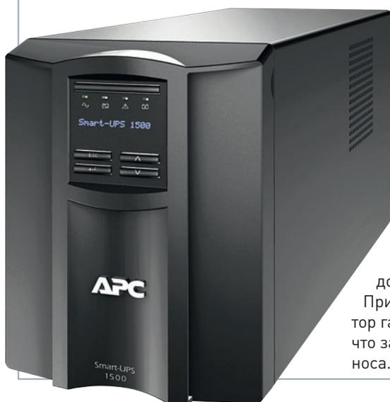
тание нагрузки при повышенном или пониженном напряжении электросети без перехода в автономный режим — в итоге продлевается срок службы аккумуляторных батарей. Режим резервного питания включится лишь при изменении напряжения на величину, которую устройство не способно скорректировать.
