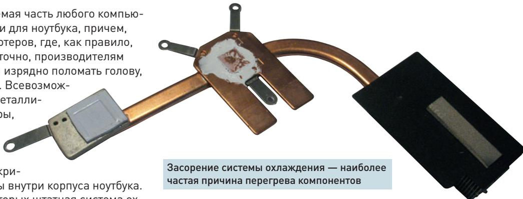
Засорение системы охлаждения — наиболее частая причина перегрева компонентов
