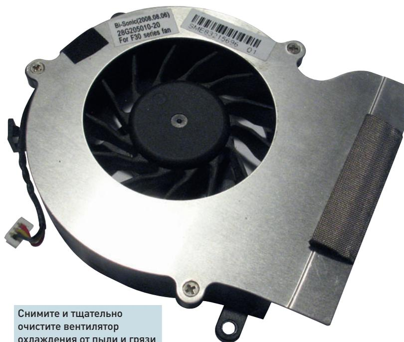
Снимите и тщательно очистите вентилятор охлаждения от пыли и грязи
