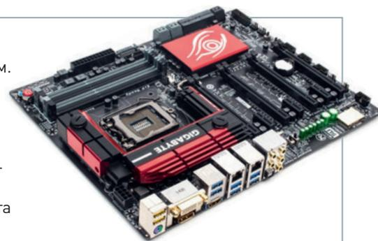
звуковым процессоре Creative Sound Core3D, защищенном металлическим экраном. Для уменьшения помех звуковой тракт частично отделен от общего массива PCB. Чтобы такое решение выглядело еще и эффектно, по периметру площадка подсвечивается красными светодиодами, установленными на оборотной стороне платы.
